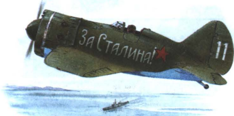
Истребитель И-16 конструктора Н.Н. Поликарпова. Его скорость 462 км/ч, вооружение: 2 пушки 20 мм и 2 пулемета 7,62 мм. Истребитель И-16 создан в 1933 году и был основным истребителем, состоявшим на вооружении ВВС Советского Союза к началу Великой Отечественной войны. Всего было построено 655 истребителей.
